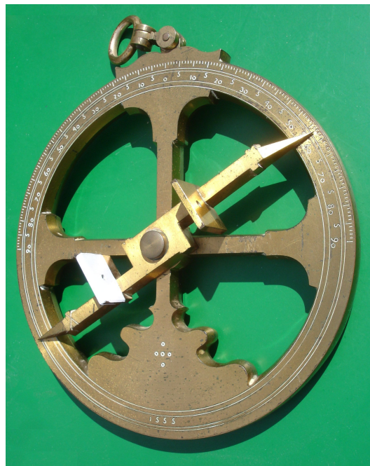
Abbildung 3.1: Seeastrolab (1555) Foto: Gudrun Wolfschmidt
