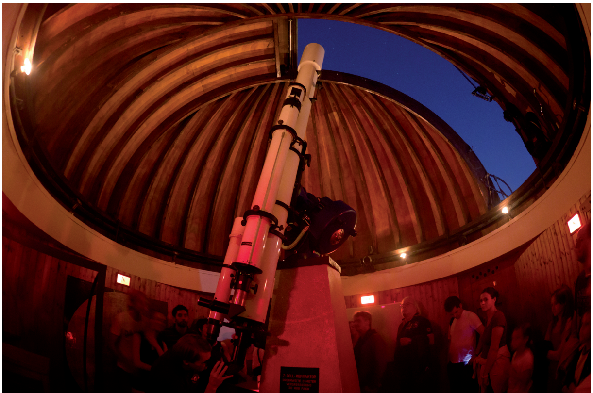
Abbildung 3.1: Volkssternwarte München, 7-Zoll-Fraunhofer Refraktor (CC4, H. Raab, User:Vesta)
